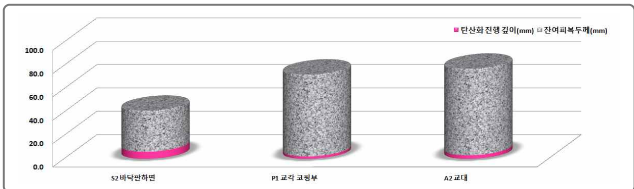
[그림 15.3.5] 탄산화깊이 및 잔여피복두께 측정결과
